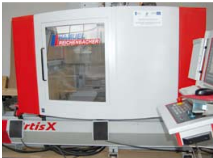
Centrum Artis X pozwala na obróbkę różnych elementów meblowych. FOT. JANUSZ BEKAS
