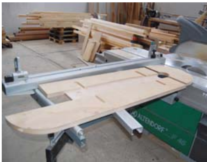
W celu uzyskania wysokiej dokładności przycinanych elementów wykorzystuje się pilarkę firmy Altendorf. FOT. JANUSZ BEKAS
