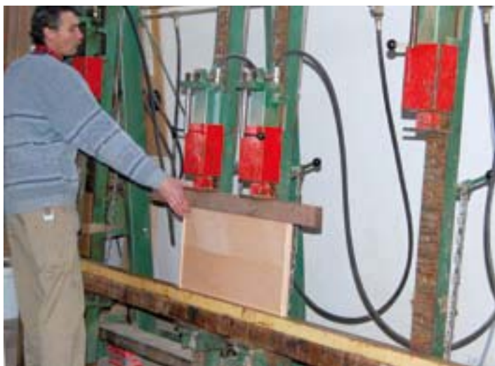
Doklejkę z forniru najszybciej wykonuje się na prasie ramowej. FOT. JANUSZ BEKAS
